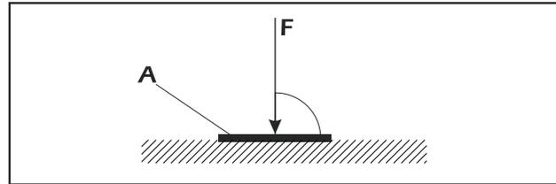
Der Druck (P) ist neben der Temperatur eine der am häufigsten gemessenen physikalischen Einheiten. Die Einheit „Pascal“ (Pa) ist die SI-Einheit des Druckes.
